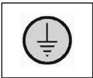
Gibt die Erdungsstelle der Elektroanlage der Maschine an
